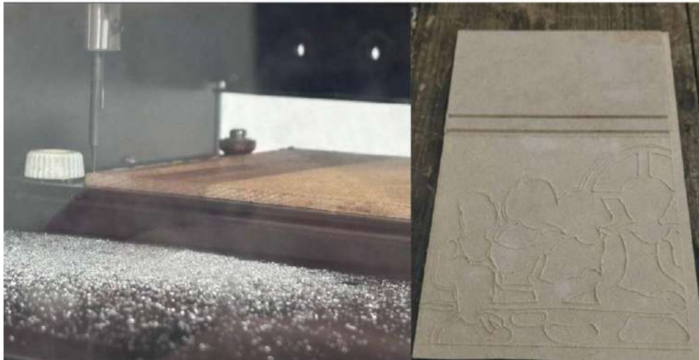
Figura 4. Máquina de controle numérico Modela Roland iniciando o processo de fresamento na placa de MDF 10x15cm. Fonte: Registros do autor.
